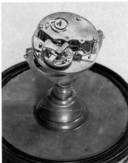
Fig. 6 - Meccanica di orologio "Carrousel" costruito per Gondolo.
